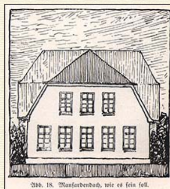
Abb. 18 Mansardendach, wie es sein soll. (Abb. nach Seite 122, unpag.)
